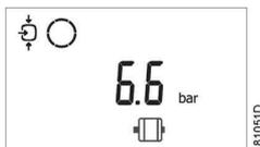
**Attenzione:** l'arresto "Sovraccarico motore" appare sia in caso di sovraccarico motore sia in caso di **sequenza fasi incorretta** (rilevata dal relè sequenza fasi) sia in caso di **sovratemperatura rilevata da uno dei termostati**.
