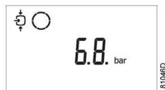
Il display mostra che il compressore sta funzionando a carico e che la pressione in mandata è di 6,8 bar. Consultare il servizio postvendita se appare la scritta <test>.
