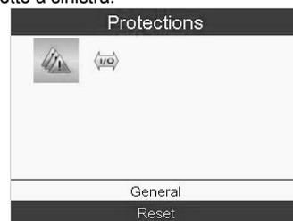
Per individuare il tipo di allarme, evidenziare il triangolo giallo (1) usando pulsanti di scorrimento. Premere Enter (Invio) e comparirà il menu Protezioni come nella figura sopra a destra. Premere Enter (Invio) e comparirà la lista delle protezioni attive nel controllore. Usare i pulsanti di scorrimento per controllare tutte le protezioni e quella che genera l'allarme sarà evidenziata come ad esempio nella figura sotto:
