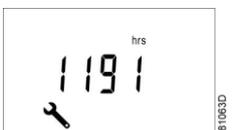
La schermata mostra l'unità di misura impiegata <hrs> (o <x1000 hrs>) ed il valore 1191 : il compressore ha funzionato per 1191 ore dall'ultimo intervento manutentivo.
