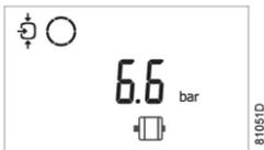
Attenzione: Il simbolo di "Sovraccarico motore" appare sia in caso di allarme inverter sia in caso di sovratemperatura rilevata dal termostato TSHH 11-12.
