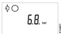
Il display mostra che il compressore sta funzionando a carico e che la pressione in mandata è di 6,8 bar.
