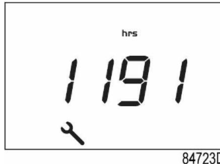
Questa schermata mostra l'unità di misura utilizzata <ore> (o <x1000 ore>) e il valore <1191>. Nell'esempio riportato, il compressore ha funzionato per 1191 ore dal precedente intervento di manutenzione.
