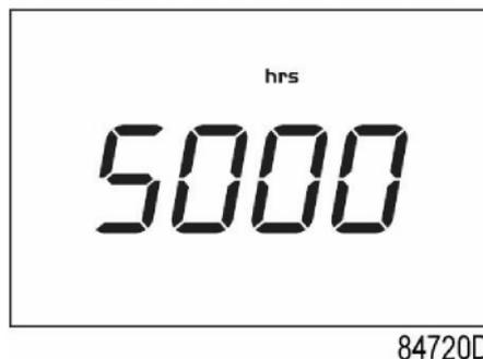
Nell'esempio raffigurato, la schermata mostra l'unità utilizzata <ore> e il valore <<5000>>: il modulo del regolatore è stato in servizio per 5000 ore.
