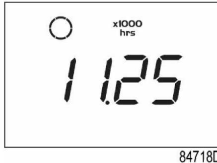
La schermata mostra l'unità utilizzata <x1000 ore> e il valore <11.25>: le ore di funzionamento del compressore sono pari a 11.250.
