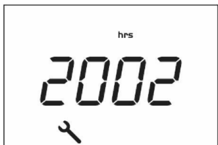
Esempio di schermata delle ore di funzionamento
