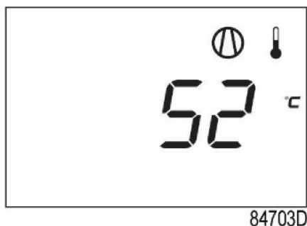
Schermata principale con temperatura (compressore spento)
