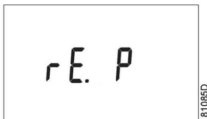
Questa schermata consente di attivare il relè di carico/scarico a distanza. Per attivare questa funzionalità di carico/scarico a distanza, è necessario un ingresso digitale fisico dotato di funzione di carico/scarico.
