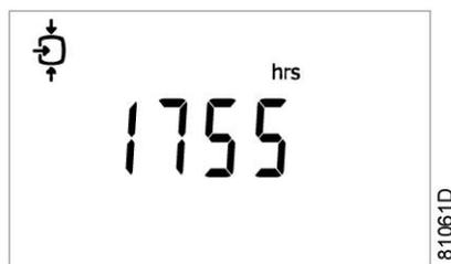
Sulla schermata viene visualizzata l'unità di misura utilizzata <ore> (o <x1000 ore>) e il valore <1755>: il compressore ha funzionato a carico per 1.755 ore.
