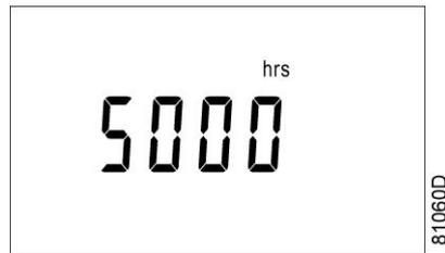
Nell'esempio riportato, sulla schermata viene visualizzata l'unità di misura in uso (ore) e il valore (5000): il modulo regolatore è stato sottoposto a manutenzione durante le 5000 ore.
